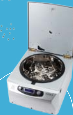
HANİL FLETA 5 MODEL SANTRİFÜJ ► Max. 5500 Rpm. ► Max. 5,411 x g ► Max. Kapasite 15 ml. x 32 ► 10 Step
